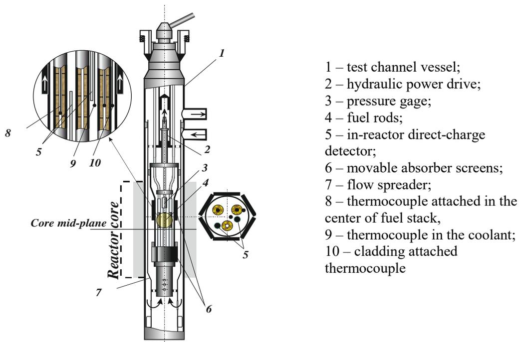
FIG. 1. Fuel Test Rig.
